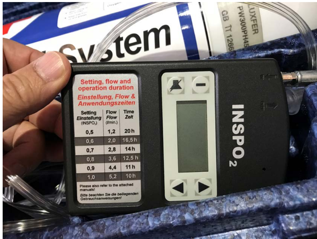
図3 この中央の数字が分時酸素流量を示しています。例えば1列目の1.2L/分であれば20時間、2列目の2 L/分であれば16.5時間継続使用可能なことを示しています。
